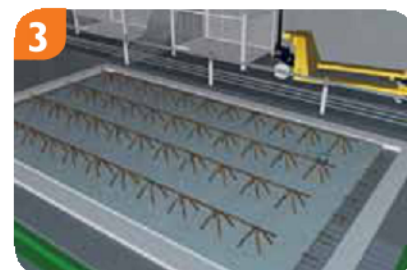
3 Zalanie formy betonem
